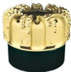
В качестве породоразрушающего инструмента, мы используем бурильные головки диаметром 215,9 мм, армированные двойным рядом алмазных породоразрушающих резцов (PDC), корпус имеет специальное износостойкое покрытие. Калибрующая поверхность усилена специальными алмазосодержащими вставками.
